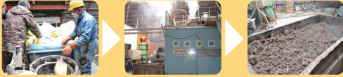
紙おむつは、高温高圧処理により減容後、埋立てています。
